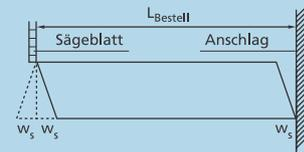
Für die Praxis muß noch der Schnittwinkel w<sub>s</sub> bekannt sein bzw. definiert werden. Falls nicht anders vereinbart, wird dieser mit w<sub>s</sub>=t<sub>s</sub>/2 angesetzt (bezogen auf die gemittelte Profilachse).
