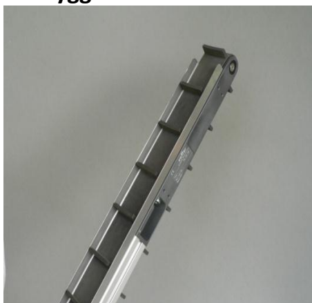
Vetter minitransportörer med inbyggda 24v DC motorer
